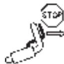
**Hinweis:** Beim Loslassen des Bremsbügels wird die Elektronik-Zündung des Motors kurzgeschlossen und die Motor-Drehzahl und somit das Messer in wenigen Sekunden abgebremst.
